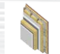
Obvodová nosná stena s kontaktnou fasádou
